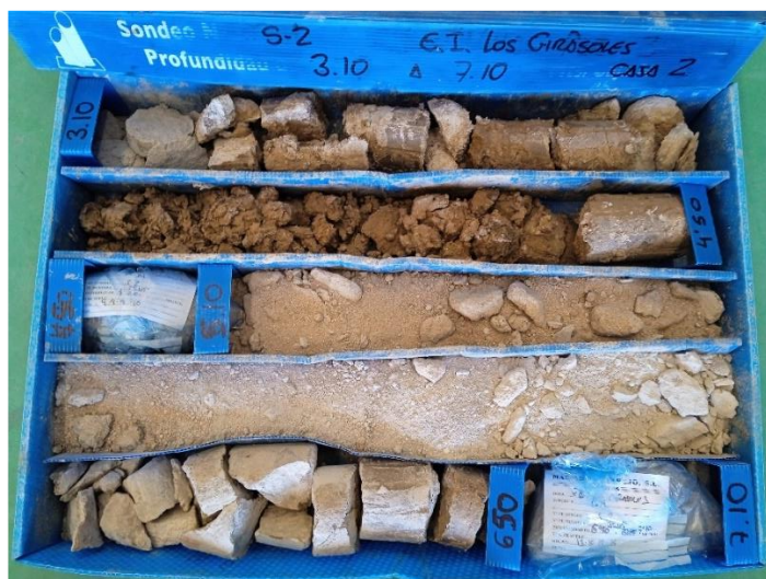
Figura 15. Posible rellenos antrópico o suelo cuaternario aluvial (sondeo S-2)
