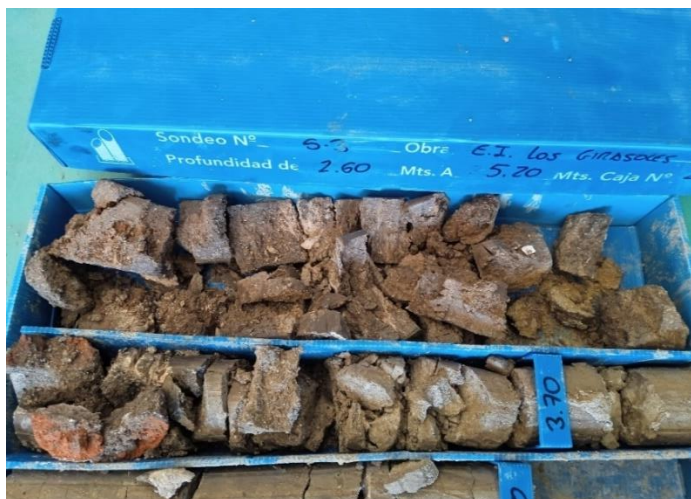
Figura 27. Detalle del terreno existente bajo la cimentación del muro de fachada
