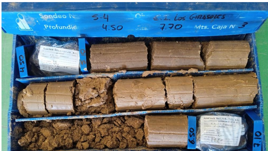
Figura 18. Sustrato terciario tosco (sondeo S-4)
