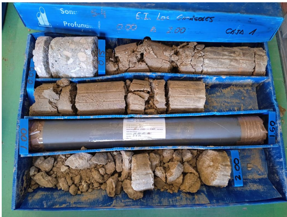
Sondeo S-4, caja 1, de 0,00 m a 2,00 m de profundidad.
