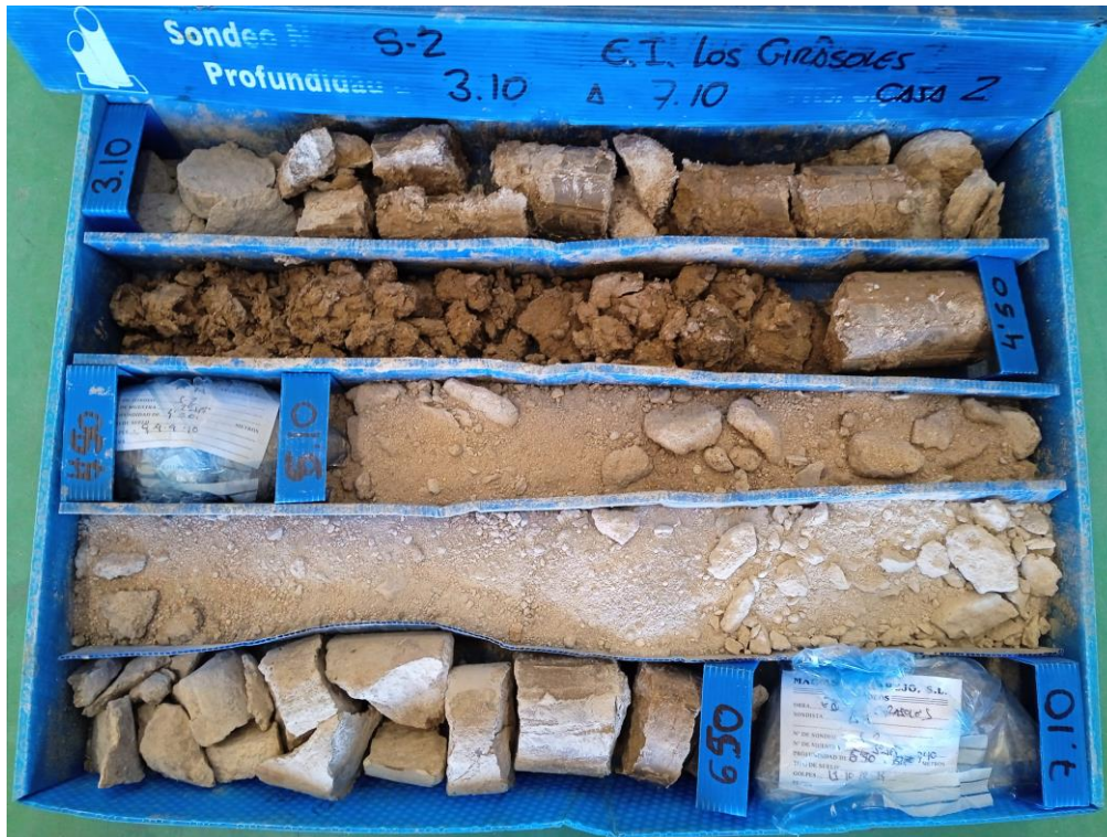
Sondeo S-2, caja 2, de 3,10 m a 7,10 m de profundidad.
