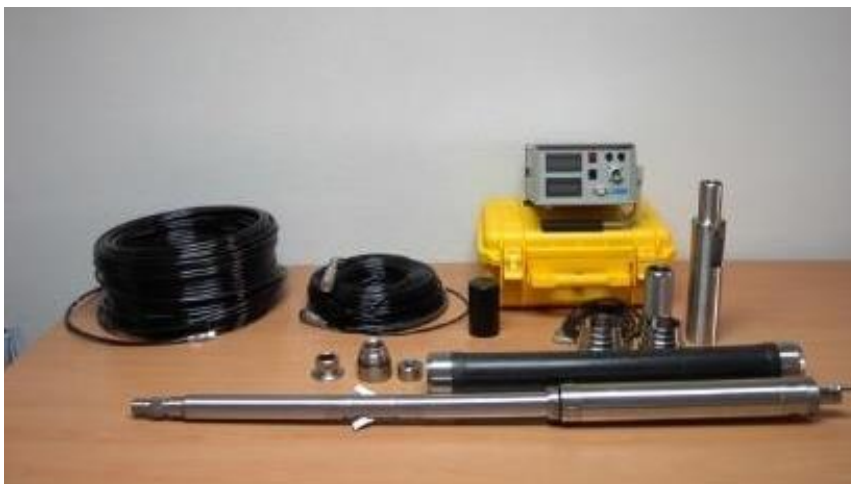
Figura 4. Equipo empleado para la realización de ensayos presiométricos
