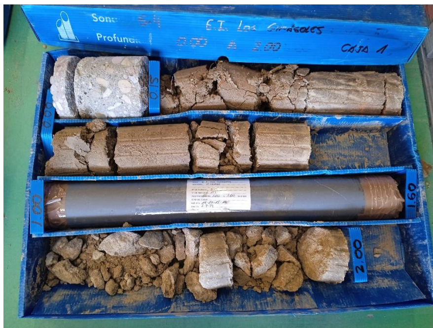
Figura 14. Rellenos antrópicos (sondeo S-4)
