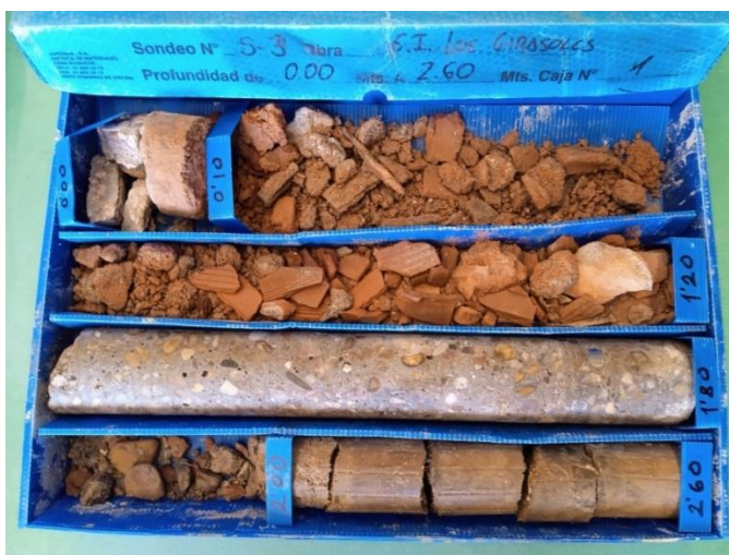
Figura 26. Aspecto del hormigón de la cimentación y terreno de apoyo
