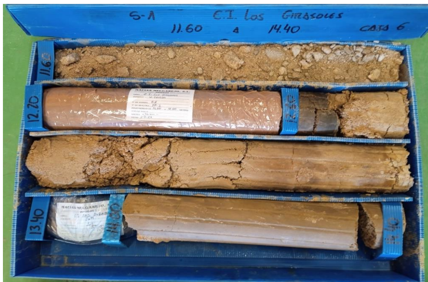
Figura 19. Sustrato terciario arenas tosquizas y toscos arenosos (sondeo S-1)
